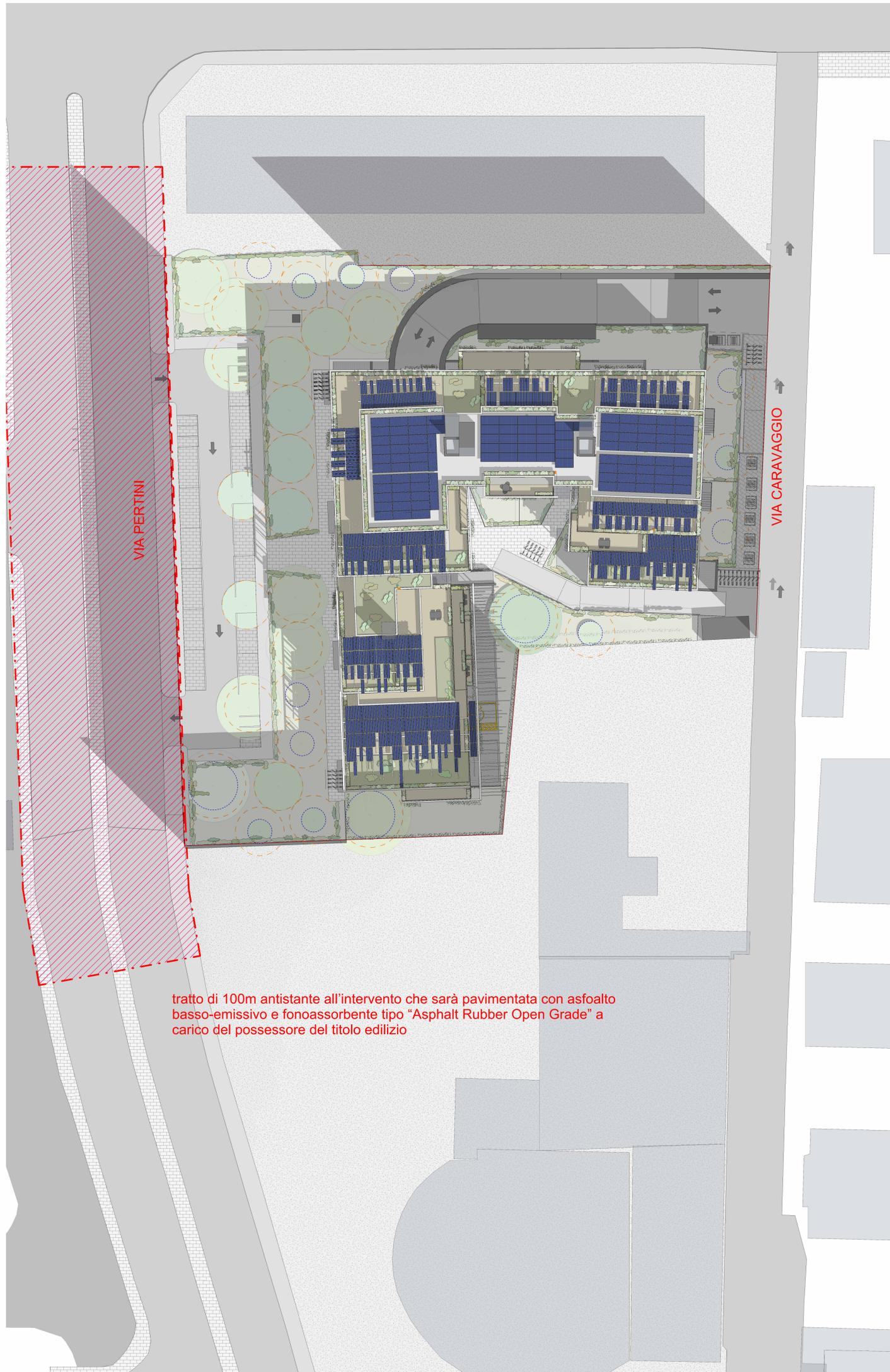
tratto di 100m antistante all'intervento che sarà pavimentata con asfalto basso-emissivo e fonoassorbente tipo "Asphalt Rubber Open Grade" a carico del possessore del titolo edilizio
